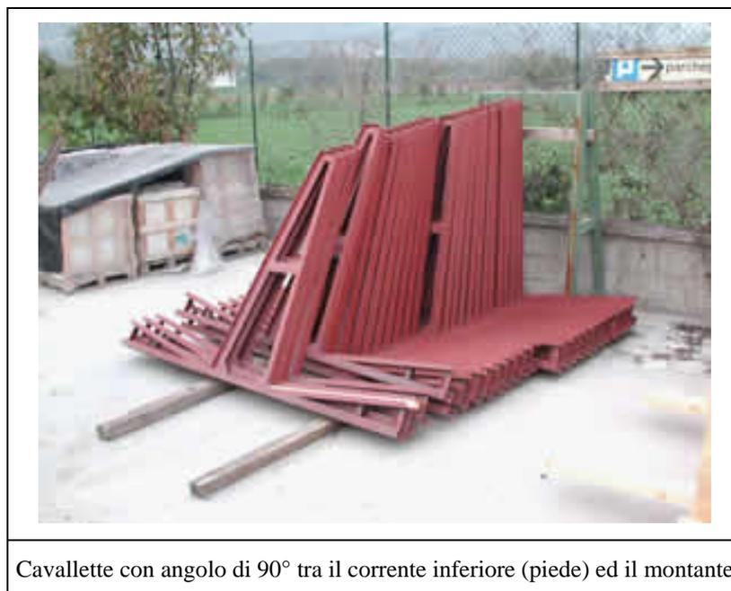
In molti casi i costruttori creano cavallette con la base metallica con inclinazione corretta verso l'interno, mentre altri permettono l'alloggiamento nel piede di un massello di legno tenero avente sempre la medesima caratteristica di inclinazione.
