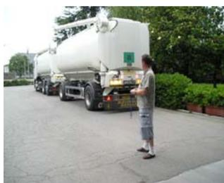
Movimentazione proboscide con radiocomando
